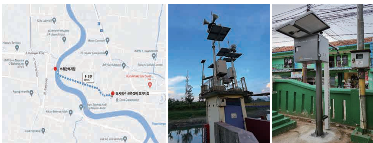
수위관측소 및 도시침수 관측장비 설치 위치도
